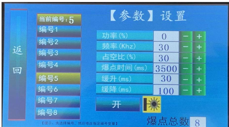
左边是参数分组编号，总共可以保存 8 组不同的参数设置，类似配方。画面右边是对应编号参数的具体参数值，可以修改，工作中可以切换参数编号。具体设置的参数有功率，频率，缓升缓降时间，爆点时间（爆点模式使用）等等。
